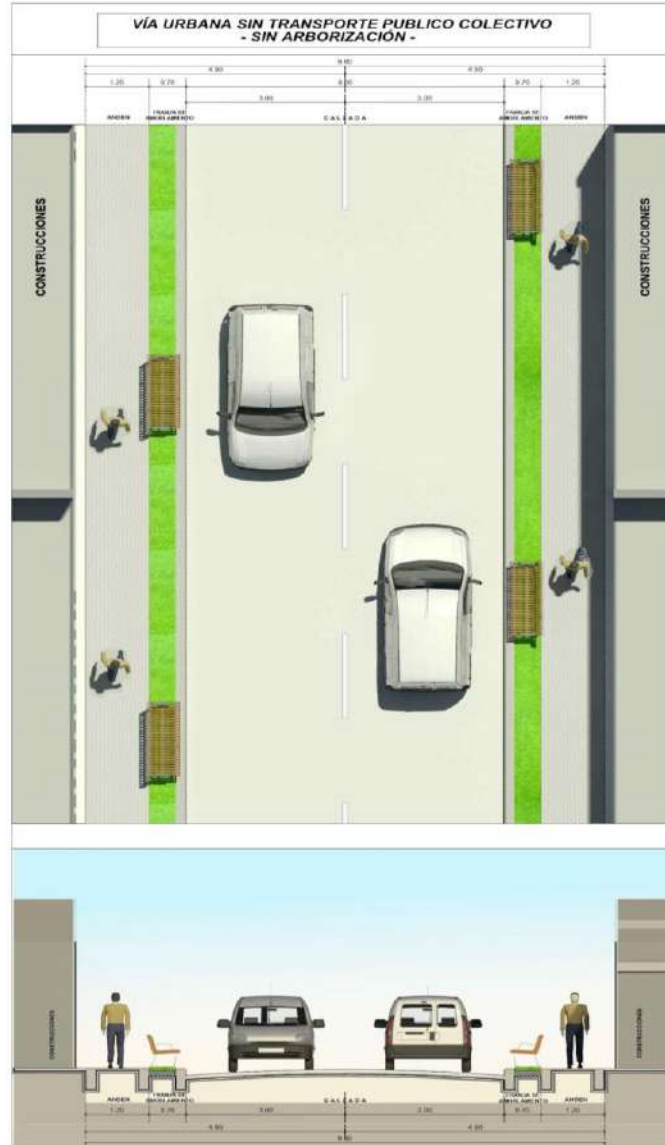
Ilustración 35. Perfil vía urbana sin transporte público colectivo sin arborización. Fuente: Arco Consultorías y Construcciones Ltda. (2021).
