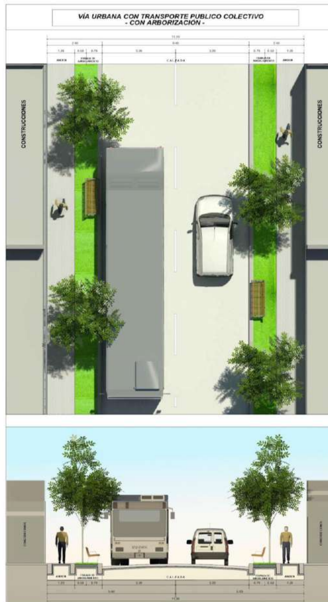
Ilustración 31. Perfil vía urbana con transporte público colectivo con arborización Fuente: Arco Consultorías y Construcciones Ltda. (2021).
