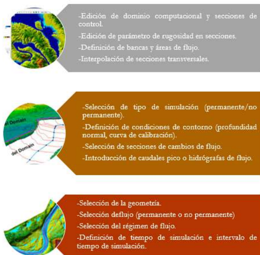
Ilustración 3. Proceso general de modelación hidráulica con HEC-RAS.
