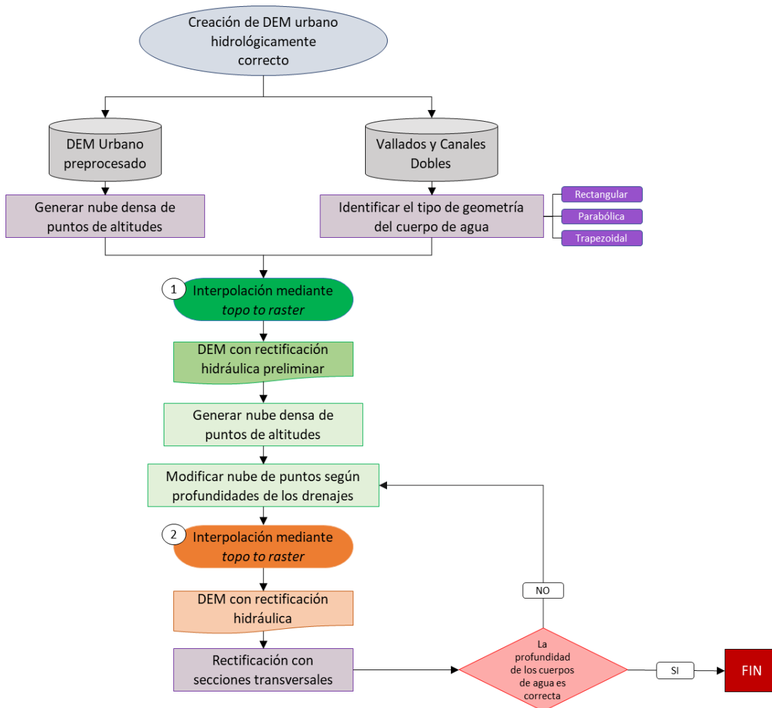
Diagrama 2. Diagrama de flujo de la metodología para obtención de modelo topobatemético.
