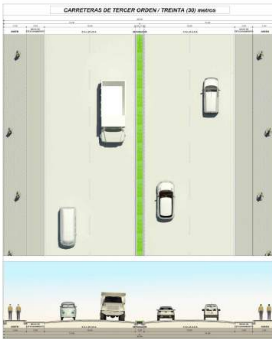
Ilustración 32. Perfil vía de tercer orden con separador angosto y andenes. Fuente: Arco Consultoría y Construcciones Ltda. (2021).
