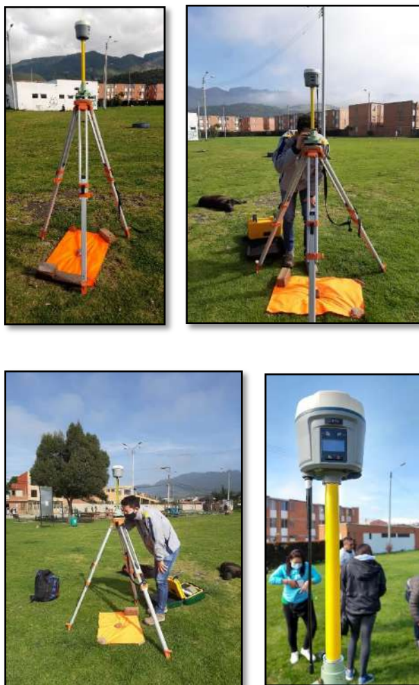
Ilustración 18. Antena GNSS Rover Base y proceso de nivelación.
