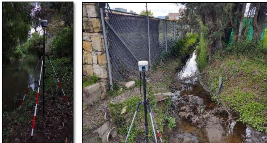
Ilustración 19. Instalación antena GNSS Rover.
