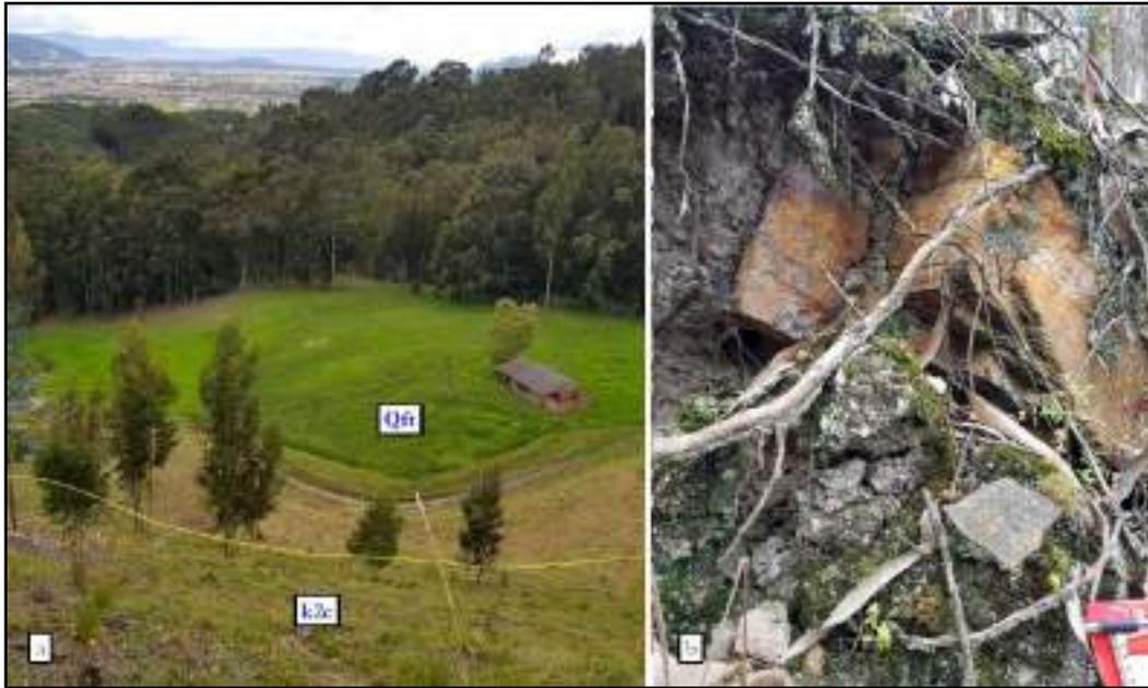
**Ilustración 92. Formación Conejo, en cercanías al Club Canino los Canes del Rey, vereda Chuntame, a) cambio morfológico entre la Formación Conejo y la unidad de Depósitos de Flujo Torrenciales, b) Arenisca diaclasada moderadamente meteorizada de la Formación Conejo.**
